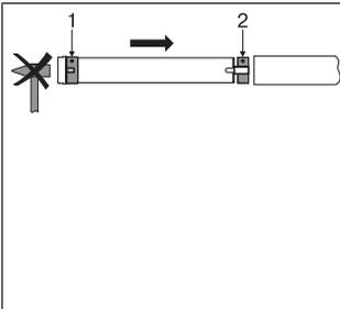
Montieren Sie den Rohrantrieb mit entsprechendem Ring (1) und Mitnehmer (2). Falls der Ring mehrere Nuten besitzt, wählen Sie die passgenaue Nut aus und schieben den Ring (1) auf den Laufring.
