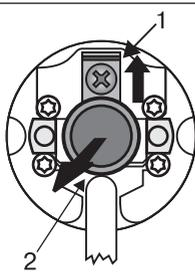
Der Steckzapfen (2) rastet beim Einschieben automatisch ein. Zum Lösen des Steckzapfens (2) das Sicherungsblech (1) nach oben schieben und den Steckzapfen (2) herausziehen.
