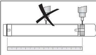
Um den Antrieb gegen axiales Verschieben zu sichern, empfehlen wir den Mitnehmer mit der Welle zu verschrauben.
