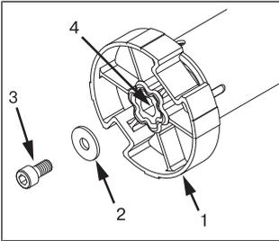
Stecken Sie den Mitnehmer (1) auf die Abtriebswelle des Rohrantriebes auf. Verwenden Sie zur Montage eine Schraube M6x12 (3) mit entsprechender Unterlegscheibe (2) und geeigneter Schraubensicherung. Gewindebohrung (4)
