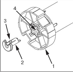
Stecken Sie den Mitnehmer (1) auf die Abtriebswelle des Rohrantriebes auf. Die Einschubposition der Mitnehmersicherung (2) ist durch seine Form vorgegeben. Beim Einschieben der Mitnehmersicherung (2) in die Rastbohrung (4) achten Sie bitte auf das Einrasten der Rastnase (3). Dies ist durch ein Klicken hörbar. Überprüfen Sie den festen Sitz der Sicherung durch Ziehen am Mitnehmer (1).
